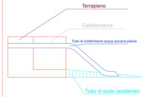
Particolare terminale sversamento acque piovane nel tubo di scolo già esistente alla base della gabbionatura
