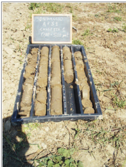
FOTO n.01 Cassetta da mt 0.00 a mt 5.00
