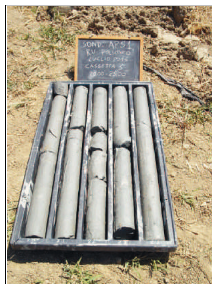
FOTO n.05 Cassetta da mt 20.00 a mt 25.00
