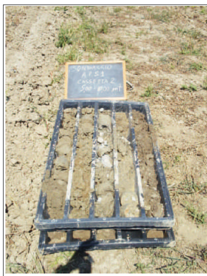
FOTO n.02 Cassetta da mt 5.00 a mt 10.00
