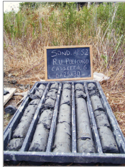
FOTO n.06 Cassetta da mt 25.00 a mt 30.00
