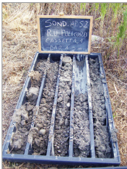
FOTO n.01 Cassetta da mt 0.00 a mt 5.00
